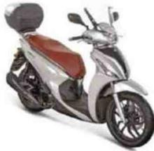
Moteur : monocylindre, 4-temps, 125 cm<sup>3</sup> à refroidissement par air, 11,28 ch, injection. Cadre : simple berceau en acier. Susp. AV/AR : fourche télescopique conventionnelle/2 amortisseurs. Freins AV/AR : 1 disque/1 disque. Pneus AV-AR : 100/80 x 16 - 120/80 x 14. Réservoir : 6,2 litres. HS : 800 mm. Poids : 130 kg pleins faits.
