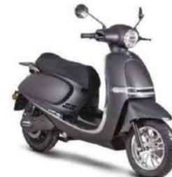
Moteur : électrique, 6,8 ch. Batterie : lithium-ion. Cadre : treillis tubulaire en acier. Susp. AV/AR : fourche télescopique conventionnelle/2 amortisseurs. Freins AV/AR : 1 disque/1 disque. Pneus AV-AR : NC-NC. Autonomie : 100 km. HS : 810 mm. Poids : 98 kg pleins faits.
