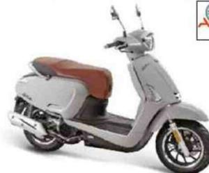
Moteur : monocylindre, 4-temps, 124,8 cm<sup>3</sup> à refroidissement par air, 11,14 ch, injection. Cadre : simple berceau en acier. Susp. AV/AR : fourche télescopique conventionnelle/2 amortisseurs. Freins AV/AR : 1 disque/1 disque. Pneus AV-AR : 110/70 x 12 - 130/70 x 12. Réservoir : 7 litres. HS : 790 mm. Poids : 120 kg pleins faits.
