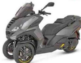
Moteur : monocylindre, 4-temps, 399 cm<sup>3</sup> à refroidissement liquide, 35,63 ch, injection. Cadre : simple berceau en acier. Susp. AV/AR : parallélogramme déformable/2 amortisseurs. Freins AV/AR : 2 disques/1 disque. Pneus AV-AR : 110/70 x 13 - 140/70 x 14. Réservoir : 13 litres. HS : 780 mm. Poids : 280 kg pleins faits.
