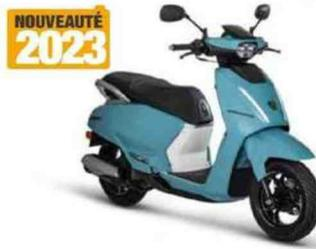
Moteur : monocylindre, 4-temps, 124,8 cm<sup>3</sup> à refroidissement liquide, 12,9 ch, injection. Cadre : treillis tubulaire en acier. Susp. AV/AR : fourche télescopique conventionnelle/mono-amortisseur. Freins AV/AR : 1 disque/1 disque. Pneus AV-AR : 110/70 x 12 - 120/70 x 12. Réservoir : 8,5 litres. HS : 778 mm. Poids : 134 kg à sec.
