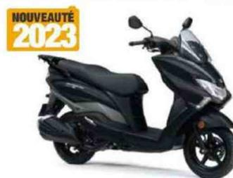
Moteur : monocylindre, 4-temps, 124 cm<sup>3</sup> à refroidissement par air, 8,7 ch, injection. Cadre : simple berceau en acier. Susp. AV/AR : fourche télescopique conventionnelle/mono-amortisseur. Freins AV/AR : 1 disque/1 tambour. Pneus AV-AR : 90/90 x 12 - 100/80 x 12. Réservoir : 5,5 litres. HS : 780 mm. Poids : 112 kg à sec.
