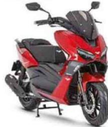
Moteur : monocylindre, 4-temps, 125 cm<sup>3</sup> à refroidissement par air, 9,7 ch, injection. Cadre : simple berceau en acier. Susp. AV/AR : fourche télescopique conventionnelle/2 amortisseurs. Freins AV/AR : 1 disque/1 disque. Pneus AV-AR : 110/70 x 13 - 130/70 x 13. Réservoir : 8 litres. HS : 800 mm. Poids : NC.
