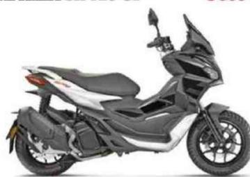
Moteur : monocylindre, 4-temps, 125 cm<sup>3</sup> à refroidissement liquide, 11 ch, injection. Cadre : treillis tubulaire en acier. Susp. AV/AR : fourche télescopique conventionnelle/2 amortisseurs. Freins AV/AR : 1 disque/1 disque. Pneus AV-AR : 110/80 x 14 - 130/70 x 13. Réservoir : 9 litres. HS : 799 mm. Poids : NC.
