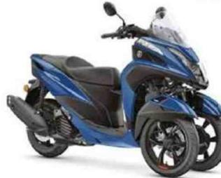
Moteur : monocylindre, 4-temps, 125 cm<sup>3</sup> à refroidissement liquide, 12,2 ch, injection. Cadre : double berceau en acier. Susp. AV/AR : fourche télescopique conventionnelle/2 amortisseurs. Freins AV/AR : 2 disques/1 disque. Pneus AV-AR : 90/80 x 14 - 130/70 x 13. Réservoir : 7,2 litres. HS : 785 mm. Poids : 168 kg pleins faits.
