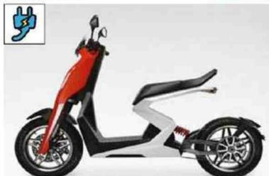
Moteur : électrique, 9,7 ch. Batterie : lithium-ion.
