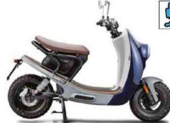
Moteur : électrique, 5,4 ch. Batterie : lithium-ion. Cadre : treillis tubulaire en acier. Susp. AV/AR : fourche télescopique conventionnelle/2 amortisseurs. Freins AV/AR : 1 disque/1 disque. Pneus AV-AR : 120/90 x 10 - 130/90 x 10. Autonomie : 80 km. HS : 830 mm. Poids : NC.
