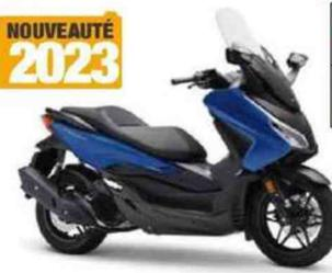
Moteur : monocylindre, 4-temps, 124 cm<sup>3</sup> à refroidissement liquide, 14,96 ch, injection. Cadre : double berceau tubulaire en acier. Susp. AV/AR : fourche télescopique conventionnelle/2 amortisseurs. Freins AV/AR : 1 disque/1 disque. Pneus AV-AR : 120/70 x 15 - 140/70 x 14. Réservoir : 11,5 litres. HS : 780 mm. Poids : 159 kg pleins faits.
