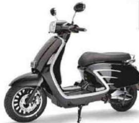
Moteur : électrique, 6,8 ch. Batterie : lithium-ion. Cadre : treillis tubulaire en acier. Susp. AV/AR : fourche télescopique conventionnelle/2 amortisseurs. Freins AV/AR : 1 disque/1 disque. Pneus AV-AR : 110/70 x 12 - 110/70 x 12. Autonomie : 100 km. HS : 780 mm. Poids : 108 kg pleins faits.
