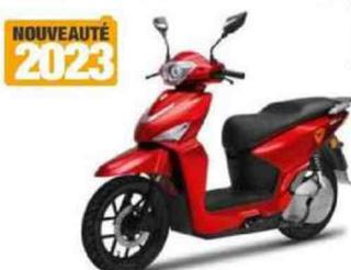
Moteur : électrique, 6,3 ch. Batterie : lithium-ion. Cadre : treillis tubulaire en acier. Susp. AV/AR : fourche télescopique conventionnelle/2 amortisseurs. Freins AV/AR : 1 disque/1 disque. Pneus AV-AR : 90/90 x 14 - 100/90 x 14. Autonomie : 200 km. HS : 700 mm. Poids : NC.
