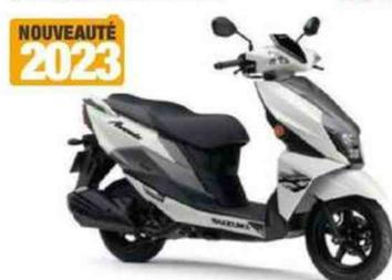
Moteur : monocylindre, 4-temps, 124 cm<sup>3</sup> à refroidissement par air, 8,7 ch, injection. Cadre : simple berceau en acier. Susp. AV/AR : fourche télescopique conventionnelle/mono-amortisseur. Freins AV/AR : 1 disque/1 disque. Pneus AV-AR : 90/90 x 12 - 90/100 x 10. Réservoir : 5,2 litres. HS : 780 mm. Poids : 107 kg à sec.
