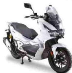
Moteur : monocylindre, 4-temps, 125 cm<sup>3</sup> à refroidissement liquide, 11 ch, injection. Cadre : treillis tubulaire en acier. Susp. AV/AR : fourche télescopique conventionnelle/2 amortisseurs. Freins AV/AR : 1 disque/1 disque. Pneus AV-AR : 110/80 x 14 - 130/70 x 13. Réservoir : 9 litres. HS : 775 mm. Poids : 149 kg pleins faits.
