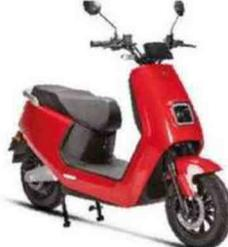
Moteur : électrique, 8,1 ch. Batterie : lithium-ion. Cadre : simple berceau en acier. Susp. AV/AR : fourche télescopique conventionnelle/mono-amortisseur. Freins AV/AR : 1 disque/1 disque. Pneus AV-AR : 120/70 x 12 - 120/70 x 12. Autonomie : 100 km. HS : 800 mm. Poids : 94,2 kg pleins faits.
