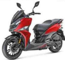
Moteur : monocylindre, 4-temps, 124,6 cm<sup>3</sup> à refroidissement par air, 10,19 ch, injection. Cadre : simple berceau en acier. Susp. AV/AR : fourche télescopique conventionnelle/mono-amortisseur. Freins AV/AR : 1 disque/1 tambour. Pneus AV-AR : 110/90 x 14 - 110/80 x 14. Réservoir : 7,5 litres. HS : 785 mm. Poids : 128 kg à sec.
