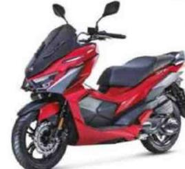
Moteur : monocylindre, 4-temps, 124,6 cm<sup>3</sup> à refroidissement liquide, 12,6 ch, injection. Cadre : simple berceau en acier. Susp. AV/AR : fourche télescopique conventionnelle/2 amortisseurs. Freins AV/AR : 1 disque/1 disque. Pneus AV-AR : 100/90 x 14 - 110/80 x 14. Réservoir : 7,5 litres. HS : 785 mm. Poids : 140 kg à sec.
