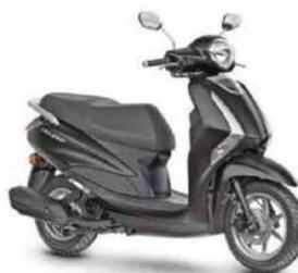
Moteur : monocylindre, 4-temps, 125 cm<sup>3</sup> à refroidissement par air, 8,4 ch, injection. Cadre : simple berceau en acier. Susp. AV/AR : fourche télescopique conventionnelle/mono-amortisseur. Freins AV/AR : 1 disque/1 tambour. Pneus AV-AR : 90/90 x 12 - 100/90 x 10. Réservoir : 5,5 litres. HS : 800 mm. Poids : 101 kg pleins faits.
