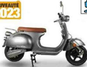
Moteur : électrique, 5,4 ch. Batterie : lithium-ion. Cadre : treillis tubulaire en acier. Susp. AV/AR : fourche télescopique conventionnelle/2 amortisseurs. Freins AV/AR : 1 disque/1 disque. Pneus AV-AR : 110/70 x 12 - 120/70 x 12. Autonomie : 80 km. HS : 800 mm. Poids : 94 kg pleins faits.
