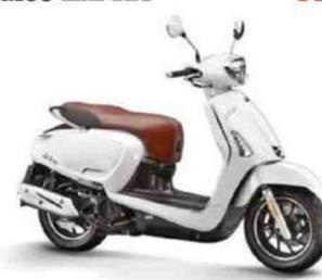
Moteur : monocylindre, 4-temps, 124,8 cm<sup>3</sup> à refroidissement par air, 11,55 ch, injection. Cadre : simple berceau en acier. Susp. AV/AR : fourche télescopique conventionnelle/2 amortisseurs. Freins AV/AR : 1 disque/1 disque. Pneus AV-AR : 110/70 x 12 - 130/70 x 12. Réservoir : 7 litres. HS : 790 mm. Poids : 115 kg pleins faits.
