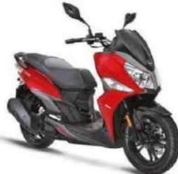
Moteur : monocylindre, 4-temps, 124,6 cm<sup>3</sup> à refroidissement par liquide, 12,6 ch, injection. Cadre : simple berceau en acier. Susp. AV/AR : fourche télescopique conventionnelle/mono-amortisseur. Freins AV/AR : 1 disque/1 disque. Pneus AV-AR : 100/90 x 14 - 110/80 x 14. Réservoir : 7,5 litres. HS : 785 mm. Poids : 137 kg à sec.
