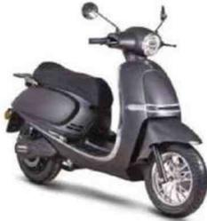
Moteur : électrique, puissance NC. Batterie : lithium-ion. Cadre : treillis tubulaire en acier. Susp. AV/AR : fourche télescopique conventionnelle/2 amortisseurs. Freins AV/AR : 1 disque/1 disque. Pneus AV-AR : NC - NC. Autonomie : 110 km. HS : 830 mm. Poids : 98 kg pleins faits.
