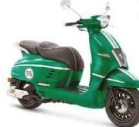
Moteur : monocylindre, 4-temps, 125 cm<sup>3</sup> à refroidissement par air, 10,2 ch, injection. Cadre : monoqueue en acier. Susp. AV/AR : fourche télescopique conventionnelle/mono-amortisseur. Freins AV/AR : 1 disque/1 disque. Pneus AV-AR : 120/70 x 12 - 120/70 x 12. Réservoir : 8,5 litres. HS : 770 mm. Poids : 143 kg à sec.
