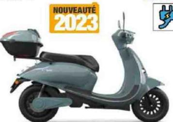
Moteur : électrique, 5,4 ch. Batterie : lithium-ion. Cadre : treillis tubulaire en acier. Susp. AV/AR : fourche télescopique conventionnelle/2 amortisseurs. Freins AV/AR : 1 disque/1 disque. Pneus AV-AR : 110/70 x 12 - 120/70 x 12. Autonomie : 80 km. HS : 770 mm. Poids : 90 kg pleins faits.
