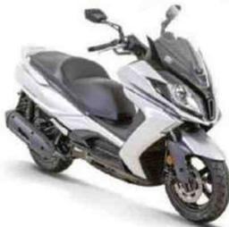
Moteur : monocylindre, 4-temps, 124,8 cm<sup>3</sup> à refroidissement liquide, 14,28 ch, injection. Cadre : simple berceau en acier. Susp. AV/AR : fourche télescopique conventionnelle/2 amortisseurs. Freins AV/AR : 1 disque/1 disque. Pneus AV-AR : 120/80 x 14 - 150/70 x 13. Réservoir : 12,5 litres. HS : 785 mm. Poids : 177 kg pleins faits.
