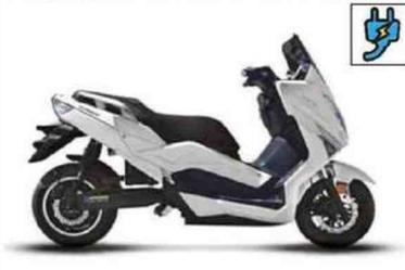
Moteur : électrique, 8,15 ch. Batterie : lithium-ion.
