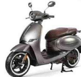
Moteur : électrique, 5,4 ch. Batterie : lithium-ion. Cadre : treillis tubulaire en acier. Susp. AV/AR : fourche télescopique conventionnelle/mono-amortisseur. Freins AV/AR : 1 disque/1 disque. Pneus AV-AR : 120/70 x 12 - 120/70 x 12. Autonomie : 120 km. HS : 710 mm. Poids : 95 kg pleins faits.
