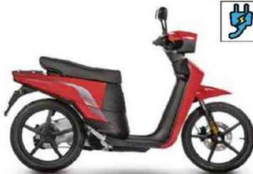
Moteur : électrique, 3,67 ch. Batterie : lithium-ion. Cadre : treillis tubulaire en acier. Susp. AV/AR : fourche télescopique conventionnelle/mono-amortisseur. Freins AV/AR : 1 disque/1 tambour. Pneus AV-AR : 80/80 x 16 - 90/80 x 16. Autonomie : NC. HS : 760 mm. Poids : 67 kg pleins faits.
