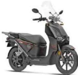
Moteur : électrique, 5,43 ch. Batterie : lithium-ion. Cadre : simple berceau en acier. Susp. AV/AR : fourche télescopique conventionnelle/mono-amortisseur. Freins AV/AR : 1 disque/1 disque. Pneus AV-AR : 90/80 x 17 - 110/70 x 17. Autonomie : NC. HS : 760 mm. Poids : NC.
