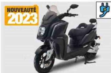
Moteur : électrique, 6,8 ch. Batterie : lithium-ion.
