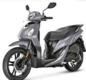
Moteur : monocylindre, 4-temps, 124,6 cm<sup>3</sup> à refroidissement par air, 11,5 ch, injection. Cadre : simple berceau en acier. Susp. AV/AR : fourche télescopique conventionnelle/2 amortisseurs. Freins AV/AR : 1 disque/1 disque. Pneus AV-AR : 110/70 x 16 - 110/80 x 16. Réservoir : 5,4 litres. HS : 790 mm. Poids : 122 kg à sec.
