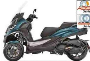
Moteur : monocylindre, 4-temps, 530 cm<sup>3</sup> à refroidissement liquide, 44,1 ch, injection. Cadre : double berceau tubulaire en acier. Susp. AV/AR : parallélogramme déformable/2 amortisseurs. Freins AV/AR : 2 disques/1 disque. Pneus AV-AR : 110/70 x 13 - 140/60 x 14. Réservoir : 13,7 litres. HS : 790 mm. Poids : 280 kg pleins faits.
