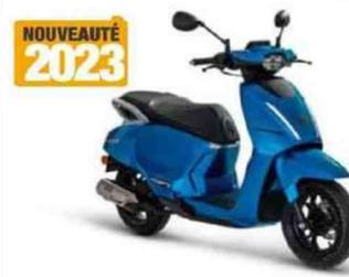
Moteur : monocylindre, 4-temps, 124,8 cm<sup>3</sup> à refroidissement par air, 10,6 ch, injection. Cadre : treillis tubulaire en acier. Susp. AV/AR : fourche télescopique conventionnelle/mono-amortisseur. Freins AV/AR : 1 disque/1 disque. Pneus AV-AR : 110/70 x 12 - 120/70 x 12. Réservoir : 8,5 litres. HS : 778 mm. Poids : 134 kg à sec.
