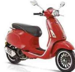
Moteur : monocylindre, 4-temps, 125 cm<sup>3</sup> à refroidissement par air, 10,74 ch, injection. Cadre : mono-coque en acier. Susp. AV/AR : monobras/mono-amortisseur. Freins AV/AR : 1 disque/1 tambour. Pneus AV-AR : 110/70 x 12 - 120/70 x 12. Réservoir : 8 litres. HS : 790 mm. Poids : NC.
