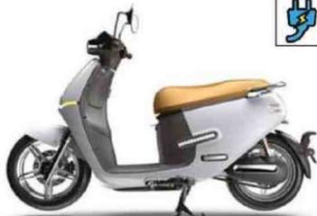
Moteur : électrique, 10,3 ch. Batterie : lithium-ion.
