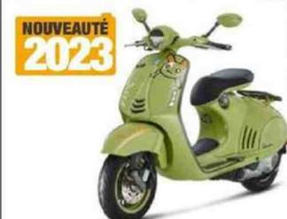
Moteur : monocylindre, 4-temps, 124,5 cm<sup>3</sup> à refroidissement liquide, 11,6 ch, injection. Cadre : mono-coque en acier. Susp. AV/AR : à bras oscillant/2 amortisseurs. Freins AV/AR : 1 disque/1 disque. Pneus AV-AR : 120/70 x 12 - 130/70 x 12. Réservoir : 7 litres. HS : 790 mm. Poids : 112 kg pleins faits.
