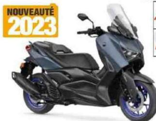
Moteur : monocylindre, 4-temps, 124,66 cm<sup>3</sup> à refroidissement liquide, puissance NC, injection. Cadre : simple berceau en acier. Susp. AV/AR : fourche télescopique conventionnelle/2 amortisseurs. Freins AV/AR : 1 disque/1 disque. Pneus AV-AR : 120/70 x 15 - 140/70 x 14. Réservoir : 13 litres. HS : 795 mm. Poids : 166 kg pleins faits.
