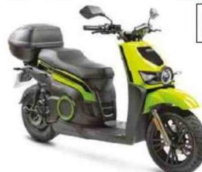
Moteur : électrique, 12,2 ch. Batterie :
