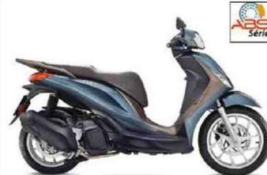
Moteur : monocylindre, 4-temps, 125 cm<sup>3</sup> à refroidissement liquide, 14,95 ch, injection. Cadre : simple berceau en acier. Susp. AV/AR : fourche télescopique conventionnelle/2 amortisseurs. Freins AV/AR : 1 disque/1 disque. Pneus AV-AR : 100/80 x 16 - 120/70 x 14. Réservoir : 7 litres. HS : 799 mm. Poids : 132 kg pleins faits.
