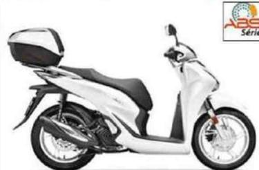
Moteur : monocylindre, 4-temps, 124,8 cm<sup>3</sup> à refroidissement liquide, 13 ch, injection. Cadre : simple berceau tubulaire en acier. Susp. AV/AR : fourche télescopique conventionnelle/2 amortisseurs. Freins AV/AR : 1 disque/1 disque. Pneus AV-AR : 100/80 x 16 - 120/80 x 16. Réservoir : 7 litres. HS : 799 mm. Poids : 136,5 kg pleins faits.
