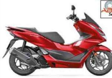
Moteur : monocylindre, 4-temps, 125 cm<sup>3</sup> à refroidissement liquide, 12,2 ch, injection. Cadre : simple berceau tubulaire en acier. Susp. AV/AR : fourche télescopique conventionnelle/2 amortisseurs. Freins AV/AR : 1 disque/1 tambour. Pneus AV-AR : 100/80 x 14 - 120/70 x 14. Réservoir : 8 litres. HS : 764 mm. Poids : 130 kg pleins faits.
