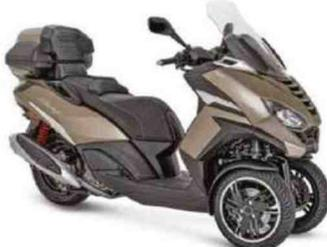
Moteur : monocylindre, 4-temps, 399 cm<sup>3</sup> à refroidissement liquide, 35,63 ch, injection. Cadre : simple berceau en acier. Susp. AV/AR : parallélogramme déformable/2 amortisseurs. Freins AV/AR : 2 disques/1 disque. Pneus AV-AR : 110/70 x 13 - 140/70 x 14. Réservoir : 13 litres. HS : 780 mm. Poids : 280 kg pleins faits.
