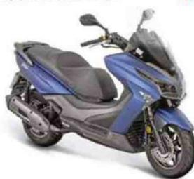
Moteur : monocylindre, 4-temps, 125 cm<sup>3</sup> à refroidissement liquide, 12,7 ch, injection. Cadre : simple berceau en acier. Susp. AV/AR : fourche télescopique conventionnelle/2 amortisseurs. Freins AV/AR : 1 disque/1 disque. Pneus AV-AR : 120/80 x 14 - 150/70 x 13. Réservoir : 12,5 litres. HS : 785 mm. Poids : 177 kg pleins faits.
