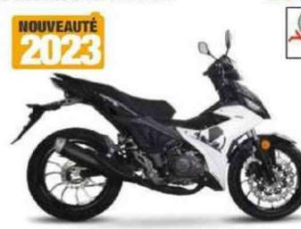
Moteur : monocylindre, 4-temps, 125 cm<sup>3</sup> à refroidissement liquide, 10,88 ch, injection. Cadre : simple berceau en acier. Susp. AV/AR : fourche télescopique conventionnelle/mono-amortisseur. Freins AV/AR : 1 disque/1 tambour. Pneus AV-AR : 90/80 x 17 - 120/70 x 17. Réservoir : 5 litres. HS : 780 mm. Poids : 123 kg à sec.
