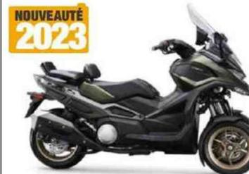
Moteur : bicylindre, 4-temps, 550,4 cm<sup>3</sup> à refroidissement liquide, 37,5 ch, injection. Cadre : treillis en acier, arrière en alu. Susp. AV/AR : 2 fourches/mono-amortisseur. Freins AV/AR : 2 disques/1 disque. Pneus AV-AR : 110/70 x 13 - 160/60 x 15. Réservoir : 15,5 litres. HS : 800 mm. Poids : 282 kg pleins faits.
