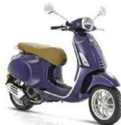
Moteur : monocylindre, 4-temps, 125 cm<sup>3</sup> à refroidissement par air, 10,73 ch, injection. Cadre : monococque en acier. Susp. AV/AR : monobras/mono-amortisseur. Freins AV/AR : 1 disque/1 tambour. Pneus AV-AR : 110/70 x 12 - 120/70 x 12. Réservoir : 8 litres. HS : 790 mm. Poids : NC.
