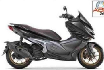
Moteur : monocylindre, 4-temps, 124,8 cm<sup>3</sup> à refroidissement liquide, NC, injection. Cadre : simple berceau en acier. Susp. AV/AR : fourche télescopique conventionnelle/2 amortisseurs. Freins AV/AR : 1 disque/1 disque. Pneus AV-AR : 100/80 x 14 - 120/70 x 14. Réservoir : 9 litres. HS : NC. Poids : 142 kg pleins faits.
