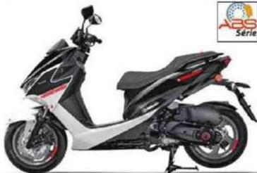
Moteur : monocylindre, 4-temps, 124 cm<sup>3</sup> à refroidissement liquide, 12,2 ch, injection. Cadre : simple berceau en acier. Susp. AV/AR : fourche télescopique conventionnelle/mono-amortisseur. Freins AV/AR : 1 disque/1 disque. Pneus AV-AR : 120/70 x 13 - 130/70 x 13. Réservoir : 7 litres. HS : 900 mm. Poids : 154 kg pleins faits.
