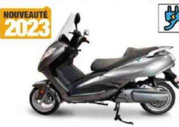
Moteur : électrique, 5,4 ch. Batterie : lithium-ion. Cadre : treillis tubulaire en acier. Susp. AV/AR : fourche télescopique conventionnelle/2 amortisseurs. Freins AV/AR : 1 disque/1 disque. Pneus AV-AR : 110/70 x 12 - 120/70 x 12. Autonomie : 100 km. HS : 770 mm. Poids : 107 kg pleins faits.
