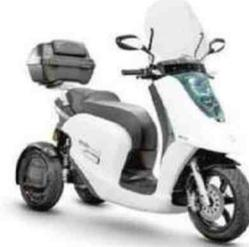
Moteur : électrique, 13,6 ch. Batterie : lithium-ion. Cadre : simple berceau tubulaire en acier. Susp. AV/AR : fourche télescopique conventionnelle/ 2 amortisseurs. Freins AV/AR : 1 disque/1 disque. Pneus AV-AR : 130/60 x 13 - 130/60 x 13. Autonomie : NM. HS : NC. Poids : 190 kg pleins faits.
