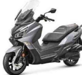
Moteur : monocylindre, 4-temps, 125 cm<sup>3</sup> à refroidissement liquide, 14,27 ch, injection. Cadre : simple berceau en acier. Susp. AV/AR : fourche télescopique conventionnelle/2 amortisseurs. Freins AV/AR : 1 disque/1 disque. Pneus AV-AR : 120/70 x 14 - 140/60 x 13. Réservoir : 12 litres. HS : 747 mm. Poids : 171 kg à sec.
