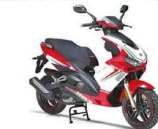
Moteur : monocylindre, 4-temps, 125 cm<sup>3</sup> à refroidissement par air, 8,84 ch, injection. Cadre : simple berceau en acier. Susp. AV/AR : fourche télescopique conventionnelle/mono-amortisseur. Freins AV/AR : 1 disque/1 disque. Pneus AV-AR : 130/60 x 13 - 130/60 x 13. Réservoir : 6,8 litres. HS : NC. Poids : 86 kg à sec.
