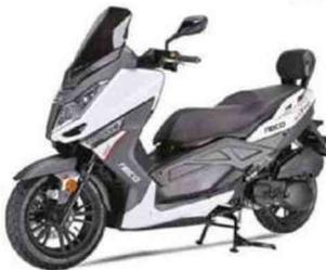
Moteur : monocylindre, 4-temps, 125 cm<sup>3</sup> à refroidissement par air, 8,16 ch, injection. Cadre : simple berceau en acier. Susp. AV/AR : fourche télescopique conventionnelle/2 amortisseurs. Freins AV/AR : 1 disque/1 disque. Pneus AV-AR : 120/80 x 14 - 130/60 x 13. Réservoir : 14 litres. HS : 775 mm. Poids : 130 kg à sec.
