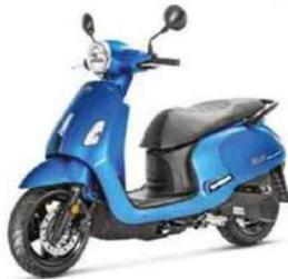
Moteur : monocylindre, 4-temps, 124,6 cm<sup>3</sup> à refroidissement par air, 11,7 ch, injection. Cadre : treillis tubulaire en acier. Susp. AV/AR : fourche télescopique conventionnelle/mono-amortisseur. Freins AV/AR : 1 disque/1 disque. Pneus AV-AR : 110/70 x 12 - 120/70 x 12. Réservoir : 6,2 litres. HS : 800 mm. Poids : 117 kg à sec.
