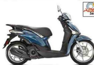
Moteur : monocylindre, 4-temps, 124 cm<sup>3</sup> à refroidissement par air, 10,88 ch, injection. Cadre : simple berceau en acier. Susp. AV/AR : fourche télescopique conventionnelle/mono-amortisseur. Freins AV/AR : 1 disque/1 tambour. Pneus AV-AR : 90/80 x 16 - 100/80 x 14. Réservoir : 6 litres. HS : 790 mm. Poids : 99 kg à sec.
