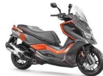
Moteur : monocylindre, 4-temps, 125 cm<sup>3</sup> à refroidissement liquide, 12,85 ch, injection. Cadre : diamant en acier. Susp. AV/AR : fourche télescopique conventionnelle/2 amortisseurs. Freins AV/AR : 1 disque/1 disque. Pneus AV-AR : 120/80 x 14 - 150/70 x 13. Réservoir : 13 litres. HS : 775 mm. Poids : 182 kg pleins faits.
