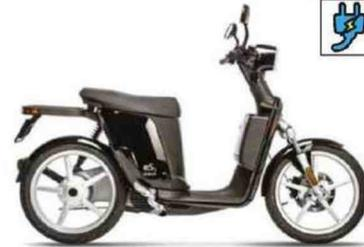
Moteur : électrique, 3,67 ch. Batterie : lithium-ion. Cadre : treillis tubulaire en acier. Susp. AV/AR : fourche télescopique conventionnelle/mono-amortisseur. Freins AV/AR : 1 disque/1 tambour. Pneus AV-AR : 80/80 x 16 - 90/80 x 16. Autonomie : NM. HS : 760 mm. Poids : 78 kg pleins faits.
