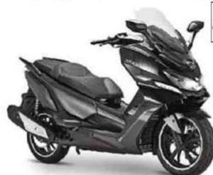
Moteur : monocylindre, 4-temps, 125 cm<sup>3</sup> à refroidissement liquide, 14,82 ch, injection. Cadre : treillis tubulaire en acier. Susp. AV/AR : fourche télescopique conventionnelle/2 amortisseurs. Freins AV/AR : 1 disque/1 disque. Pneus AV-AR : 120/70 x 15 - 140/60 x 14. Réservoir : 12 litres. HS : 752 mm. Poids : 185 kg à sec.
