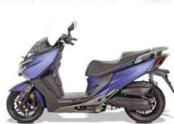
Moteur : monocylindre, 4-temps, 125 cm<sup>3</sup> à refroidissement liquide, 12,9 ch, injection. Cadre : simple berceau en acier. Susp. AV/AR : fourche télescopique conventionnelle/2 amortisseurs. Freins AV/AR : 1 disque/1 disque. Pneus AV-AR : 120/70 x 13 - 150/70 x 13. Réservoir : 10,5 litres. HS : 765 mm. Poids : 179 kg pleins faits.
