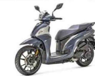
Moteur : monocylindre, 4-temps, 124,6 cm<sup>3</sup> à refroidissement liquide, 12,5 ch, injection. Cadre : simple berceau en acier. Susp. AV/AR : fourche télescopique conventionnelle/2 amortisseurs. Freins AV/AR : 1 disque/1 disque. Pneus AV-AR : 110/70 x 16 - 110/80 x 14. Réservoir : 7,5 litres. HS : 792 mm. Poids : 134 kg à sec.
