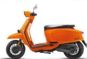
Moteur : monocylindre, 4-temps, 124,7 cm<sup>3</sup> à refroidissement par air, 10,2 ch, injection. Cadre : monocoque en acier. Susp. AV/AR : fourche télescopique conventionnelle/mono-amortisseur. Freins AV/AR : 1 disque/1 disque. Pneus AV-AR : 110/70 x 12 - 120/70 x 12. Réservoir : 6 litres. HS : 800 mm. Poids : NC.
