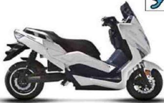
Moteur : électrique, 8,15 ch. Batterie : lithium-ion. Cadre : treillis tubulaire en acier. Susp. AV/AR : fourche télescopique conventionnelle/2 amortisseurs. Freins AV/AR : 1 disque/1 disque. Pneus AV-AR : 130/60 x 13 - 130/60 x 13. Autonomie : 60 km. HS : 780 mm. Poids : 140 kg pleins faits.
