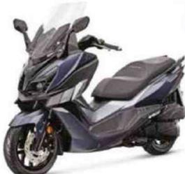
Moteur : monocylindre, 4-temps, 124,9 cm<sup>3</sup> à refroidissement liquide, 14,26 ch, injection. Cadre : simple berceau en acier. Susp. AV/AR : fourche télescopique conventionnelle/2 amortisseurs. Freins AV/AR : 1 disque/1 disque. Pneus AV-AR : 120/70 x 14 - 140/60 x 13. Réservoir : 12 litres. HS : 750 mm. Poids : 180 kg pleins faits.
